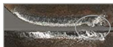
Wykruszenia krawędzi skrawającej
